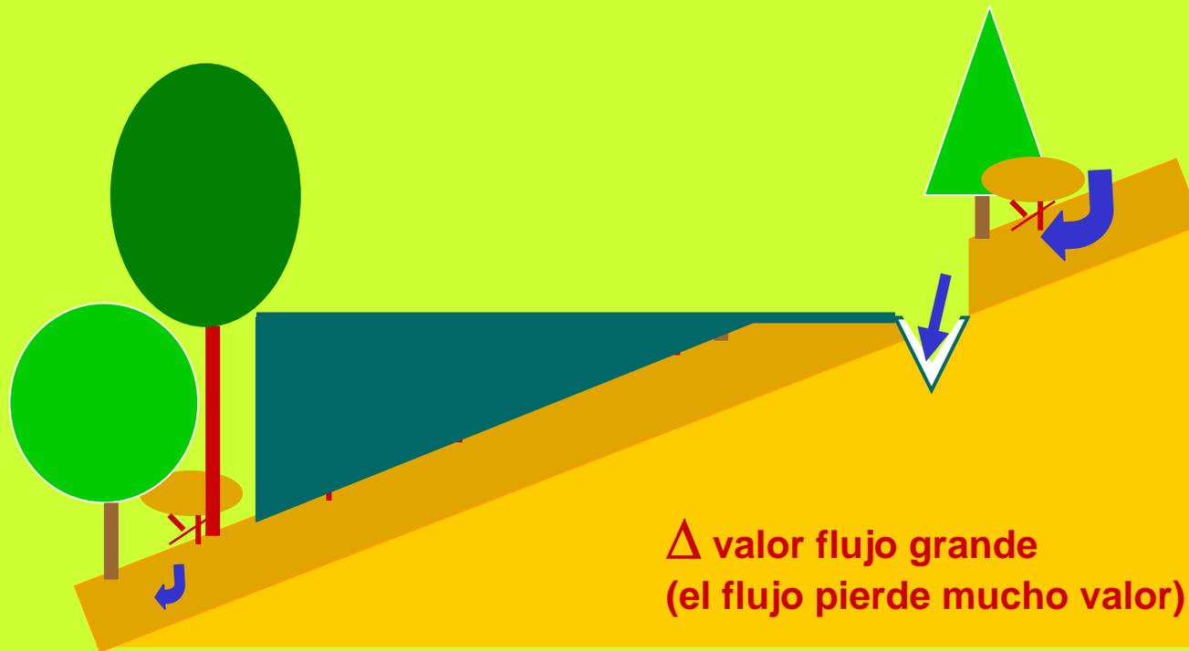
**Figura 4.2.7.1.5.** Afección del flujo hídrico en una ladera de pendiente y cobertura vegetal dadas debido al trazado de una carretera (ver Fig. 4.2.7.1.2a).
